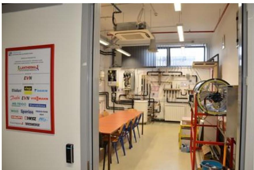
Sustav čini laboratorijska oprema, uključuju hibridni sustav s fotonaponskim pretvornicima i vjetroagregatom, solarni toplinski sustav, plinski kotao, dizalicu topline zrak-voda, spremnik PTV-a, razvodno-regulacijsku instalaciju te potrošače energije, primjerice radijator, ventilokonvektor i sustav površinskoga grijanja.
