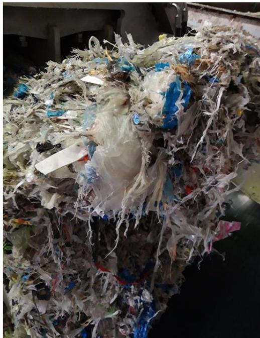
Nakon uvođenja sirovine u sustav u pulperu se formira tzv. 'pletenica'. 'Pletenica' na sebe prikuplja komade plastike, metalne žice i sl. Ukoliko su te količine prevelike, 'pletenica' puca što zahtjeva njeno vađenje iz pulpera te ručno čišćenje. Čim više nečistoća izlazi tim je veći trošak njihova zbrinjavanja.
